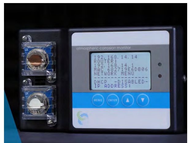
Monitor de Corrosión de Cu y Ag
